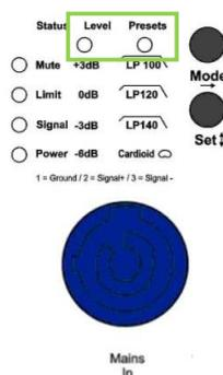
Die abrufbaren Lautsprecher-Presets können im DSP Controller auf bis zu 3 Bänke programmiert sein. Die Umschaltung der Bänke erfolgt durch Drücken und Halten der Mode-Taste während des Einschaltvorgangs.
