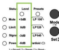
Durch einmaliges Drücken der Mode-Taste gelangen Sie in den Levelmodus, der Lautstärkeanpassungen in 3 dB Schritten erlaubt. Es stehen vier verschiedene Werte +3 dB, 0 dB (Standard), -3 dB und -6 dB zur Verfügung. Die Einstellung erfolgt durch den Taster „Set“. Die darüber befindliche grüne LED gibt Auskunft darüber, in welchem Modus Sie sich befinden, wobei die vier senkrecht angeordneten LED's (nun grün leuchtend) den jeweils eingestellten Wert angeben.
