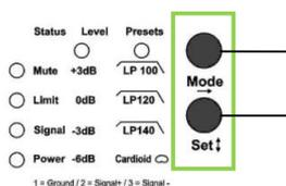
Das gleichzeitige Drücken der Set- und Mode-Taste von mehr als drei Sekunden bewirkt eine Sperrung der Bedienfunktionen. Die Aufhebung dieser Sperrung erfolgt durch wiederholtes Drücken der beiden Tasten in gleicher Weise.
