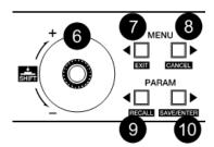
**Die Tasten MENU rechts und links (7, 8)** erlauben das Blättern in den verschiedenen Seiten der Konfigurationsmenüs des Geräts.
