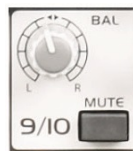
Abb. 4.6 Balance-Regler und Mute-Schalter
