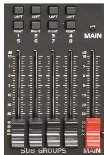
Abb. 4.18 Subgruppen- und Main-Mix-Fader
