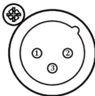
7. 3-Pin-XLR-Anschluss am Ausgang MAIN OUT
